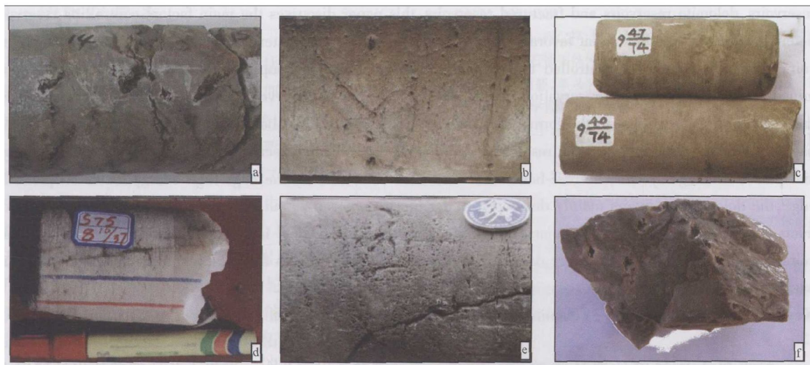
a. TS1井, 8 405.8-8 406 m, 灰白色微粉晶白云岩, 发育不规则溶蚀孔洞, 孔径1-50 mm, 多为5-15 mm, 孔壁多见白云石晶簇; b. TS1井, 7 013.15-7 013.45 m, 浅灰色粉细晶白云岩, 溶洞溶孔较为发育, 孔径0.5-2 mm, 个别大于3 mm, 多数孤立分布, 少数与裂缝连通; c. T615井, 溶洞充填, 浅褐灰色油浸细砂岩; d. S75井洞穴巨晶方解石内高角度微构造裂隙含油并渗出; e. DG1井, 寒武系, 6 259.2 m, 灰色粉晶白云岩, 溶蚀孔隙发育; f. XH2, 上寒部统, 5 590.5m, 浅灰色泥晶白云岩, 溶蚀孔洞发育, 洞内白云石半充填
